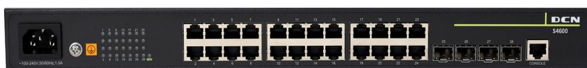
图 1-15 S4600-28P-SI R4 交换机前面板
