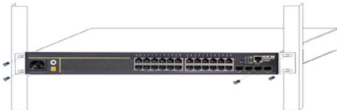
图2-2 将交换机固定在机架上
