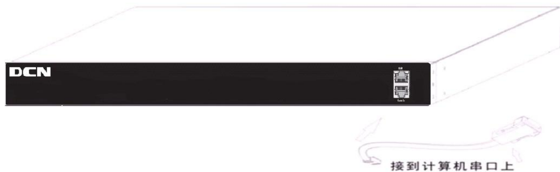
图 2-3 将Console 线缆连接到交换机上示意图
