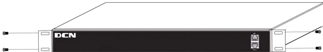
图2-1 将角铁固定在交换机上示意图
