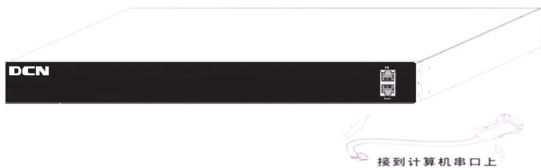
图 2-3 将Console 线缆连接到交换机上示意图
