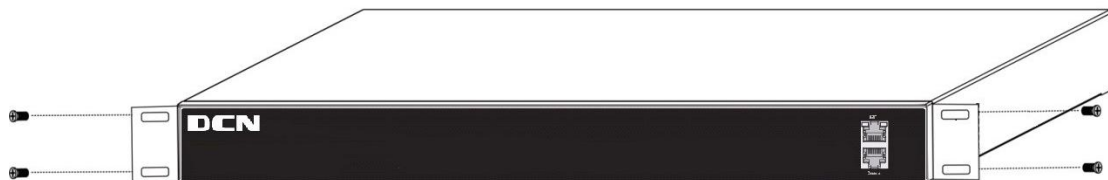
图2-1 将角铁固定在交换机上示意图
