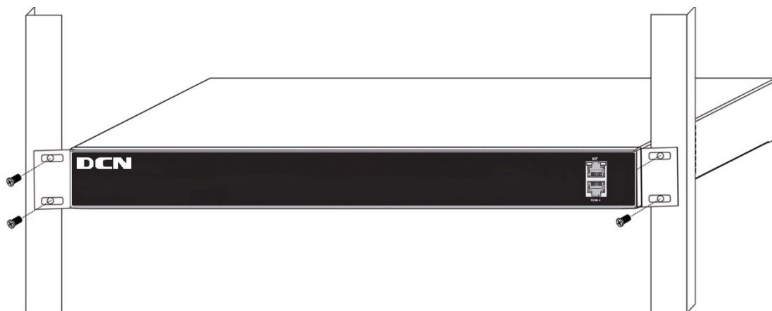
图1-2 将交换机固定在机架上示意图
