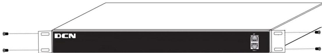
图1-1 将角铁固定在交换机上示意图
