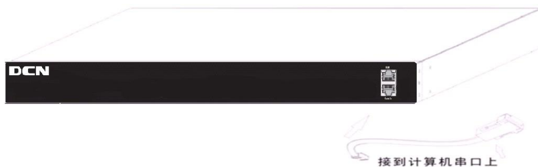
图 1-3 将Console 线缆连接到交换机上示意图
