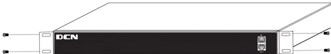
图2-1 将角铁固定在交换机上示意图
