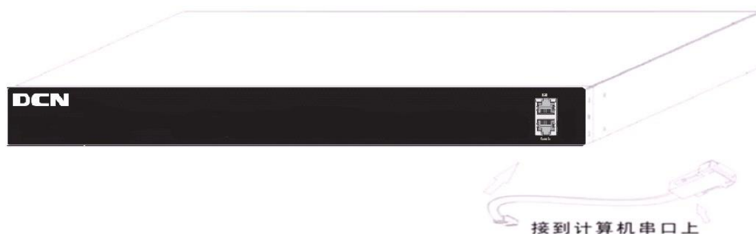
图 2-3 将Console 线缆连接到交换机上示意图
