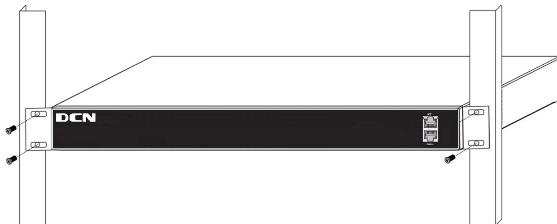
图2-2 将交换机固定在机架上示意图
